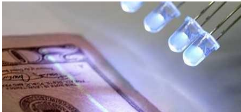
Recursos antifalsificação em uma nota de US $ 20 revelada por um LED UVA de 400nm.
