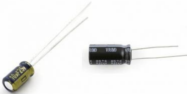
Capacitores eletrolíticos de 10 \mu F (esquerda) e 1mF (direita)
