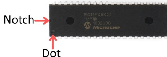
Polaridade do Circuito Integrado
